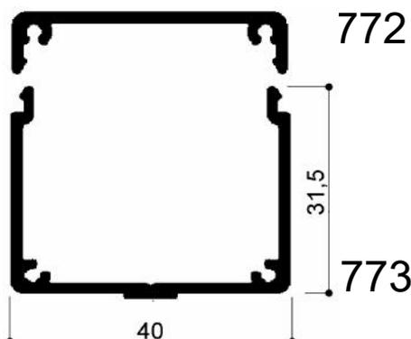
PROFILATO PER GUIDE DI FINE CORSA DISEGNI META' DEL VERO (1:2)- SCALE 1:2
