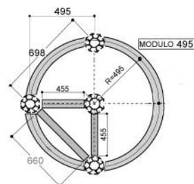
Profili curvati e traverse per la realizzazione di moduli da 1mt o 1/2 mt. Tali particolari sono fornibili grezzi, anodizzati (nero o bianco) o verniciati.
